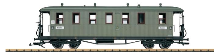
Beide Wagen mit originalgetreuer Farbgebung und Beschriftung der sächsischen Staatseisenbahn. Die Türen an den Plattformen können geöffnet werden und beide Wagen verfügen neben einer kompletten Inneneinrichtung auch über Metallradsätze.
